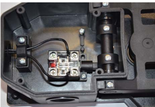
Schließen Sie das Fußpedal Anschluss an Klemmen 13 und 14.
